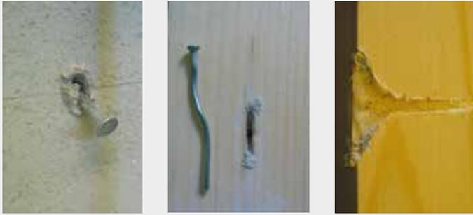
Plastische Verformung und Lochaufweitung nach der zyklisch-dynamischen Beanspruchung der Konstruktion. **fermacell** Gipsfaser-Platten (links), Holzunterkonstruktion mit verformtem Verbindungsmittel (Mitte), Schnitt durch Holzunterkonstruktion (rechts)
