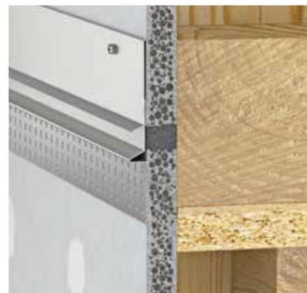
Bild 5: Befestigung des Profils (Detail)
