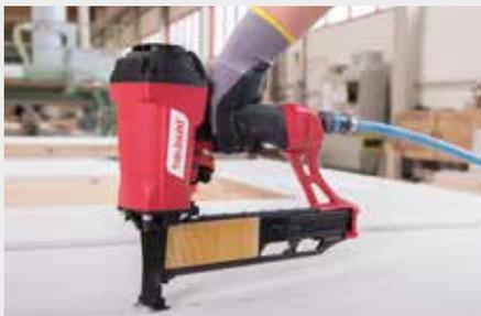
Bild 1: Klammergerät zur manuellen Befestigung
