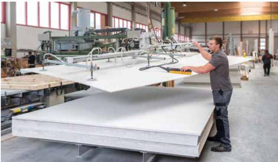
Transport von **fermacell** Gipsfaser-Platten mit einem Vakuum-Hebegerät
