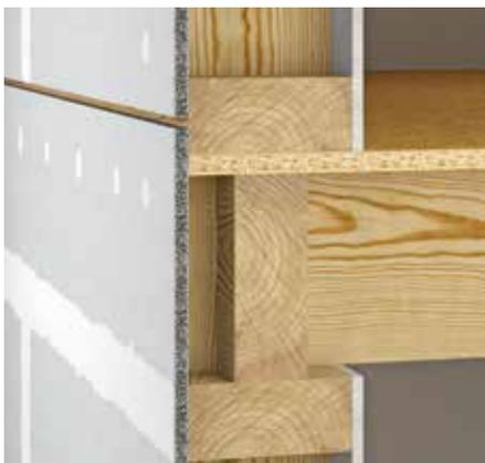
Bild 3: Mit HD-Fugentechnik versehener Bereich des Plattenstreifens
