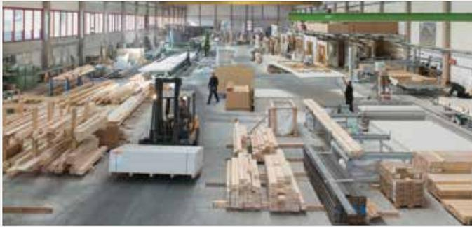
Fertigung von Holzbauelementen mit **fermacell** Gipsfaser-Platten
