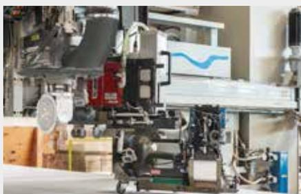
Bild 2: Klammerbrücke zur maschinellen Befestigung
