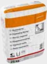
Der **fermacell** Quellmörtel dient zum Verfüllen des Hohlraumes zwischen Bodenplatte und Ständerwand im Holzbau/ Holztafelbau und übernimmt nach dem Aushärten die vollflächige Lastübertragung der Wand zum Untergrund.
